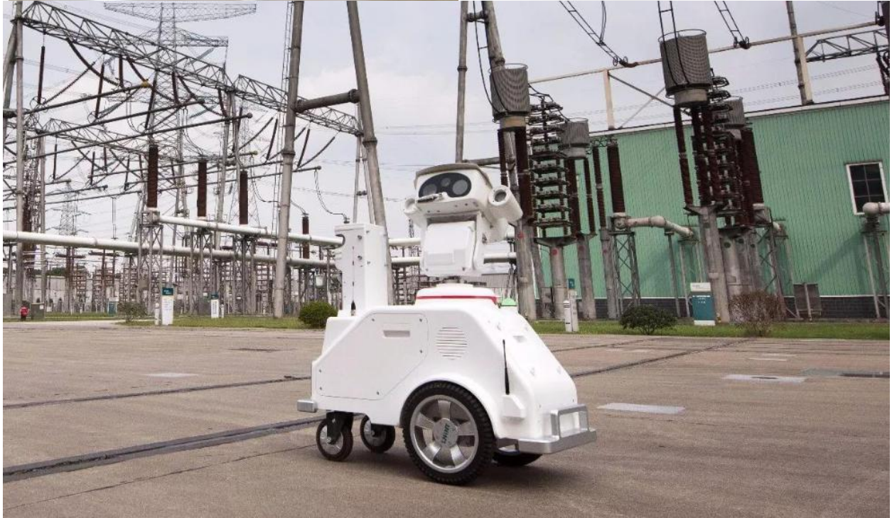
电力巡检机器人/AGV 物流小车
